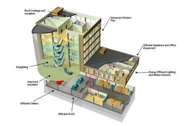
➤ 質量定性分析 "冷暖及通風空調系統"的有效的能源管理,包括冷凍水供應和室內空氣的溫度的設定,保證建築物內設計達到總熱能傳送值(OTTV)的要求,蒸發式冷卻冷凝器,變速泵,自動清洗設備,海水冷卻冷凝器,清新空氣的攝入量控制等
